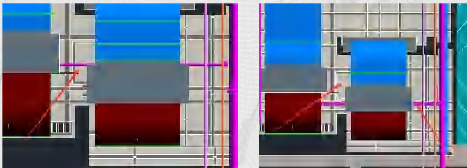
深化前：喷淋支管位于检修口上方 深化后：喷淋支管不影响检修
